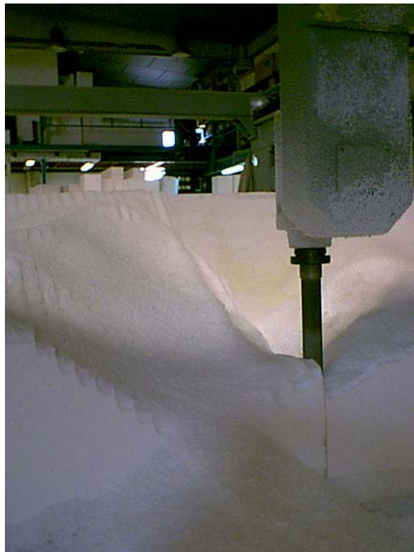
Figura 2.- Cabezal de la fresadora trabajando en uno de los moldes
